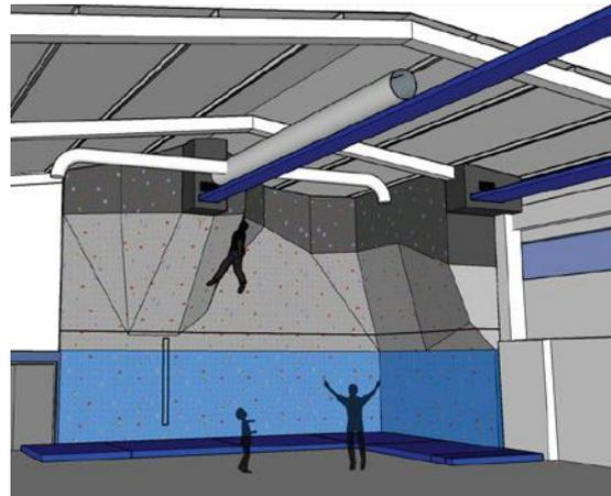
Geplante Kletterwand mit einer Fläche von 110 m<sup>2</sup> und Überhängen
